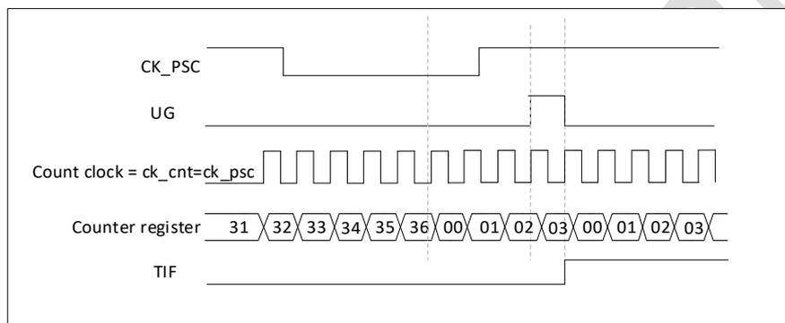
图 18-46 复位模式下的控制电路
