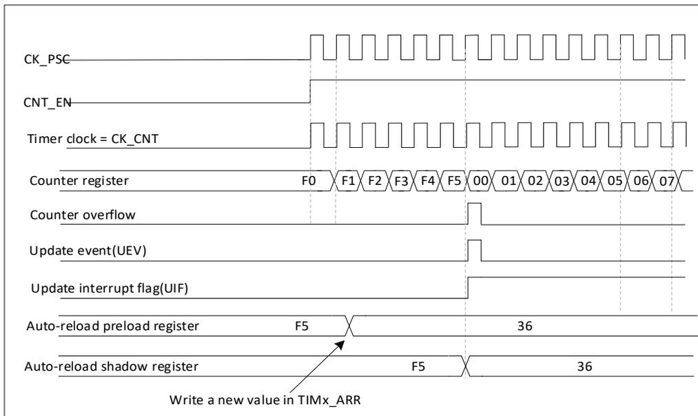
图 21-9 计数器时序图，当 ARPE=1 时的更新事件
