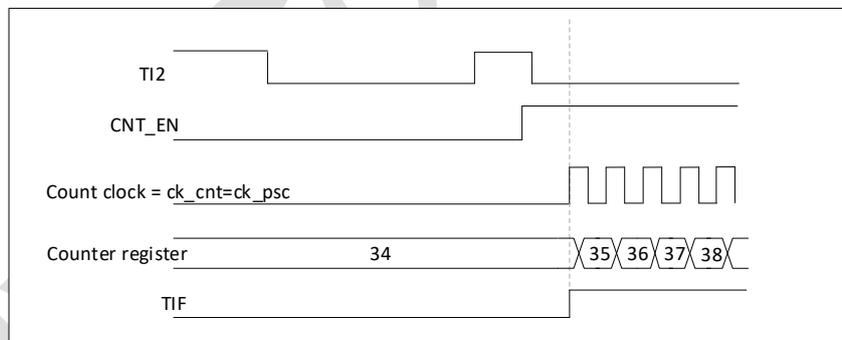
图 18-48 门控模式下的控制电路
