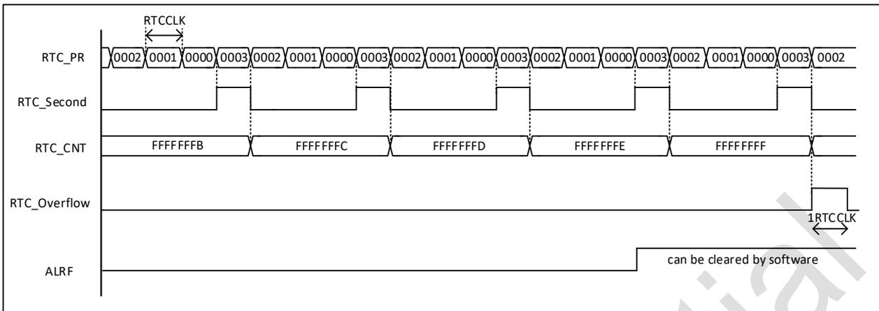
图 26-3 RTC 溢出波形图示例，PR=0003
