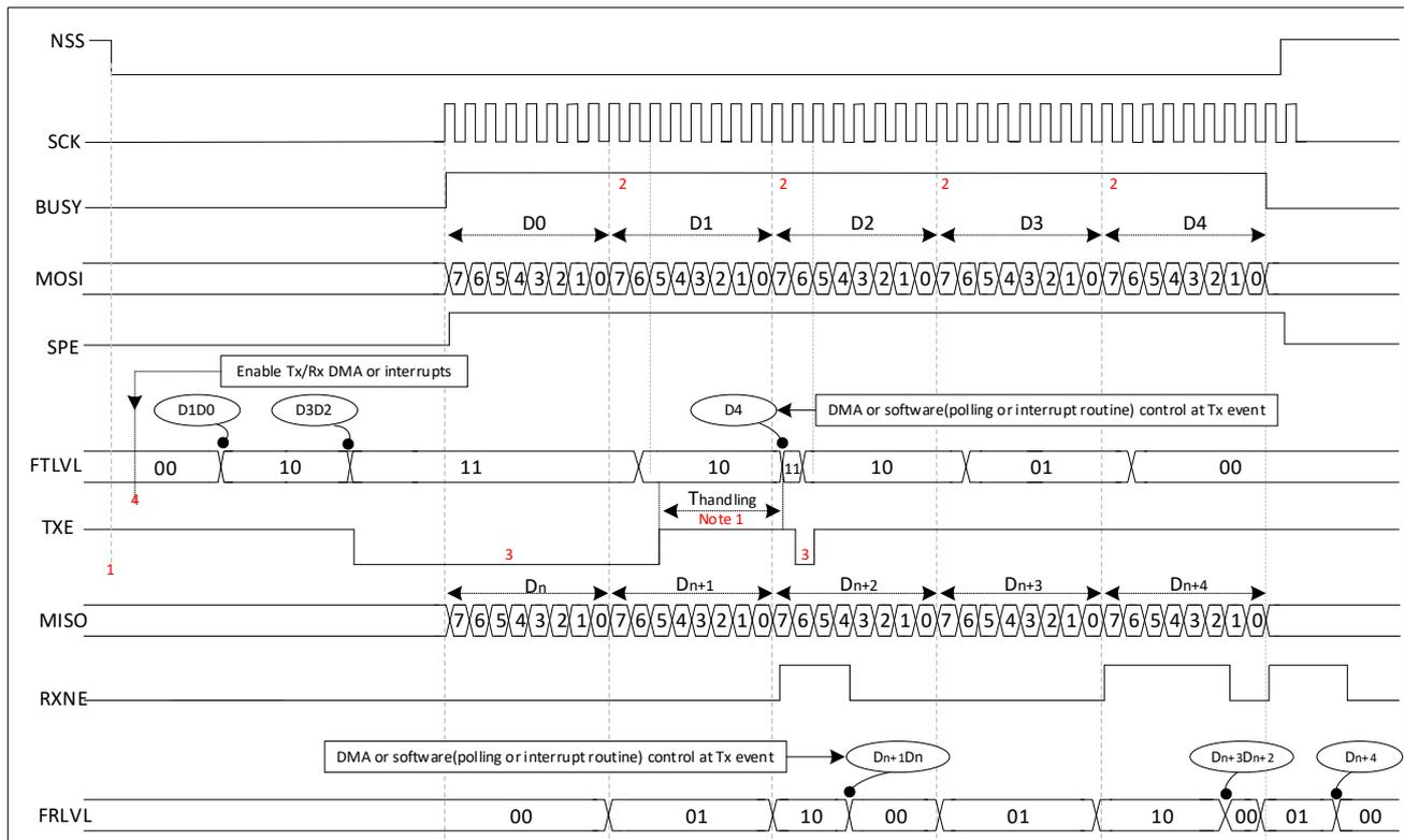
图 29-9 主机全双工通信图(bit frame=8)
