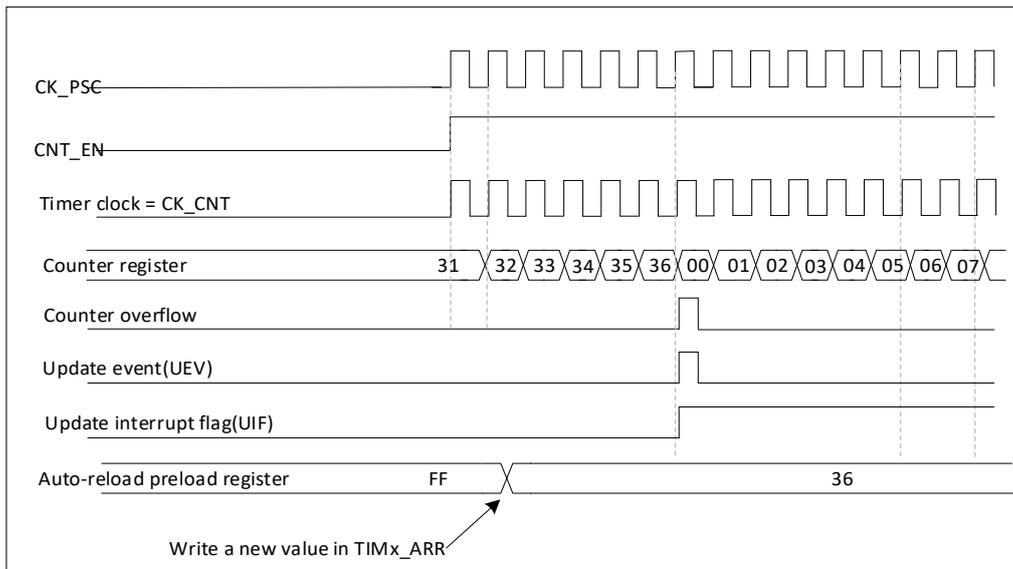
图 18-8 计数器时序图，当 ARPE=0 时的更新事件(TIM1\_ARR 没有预装入)
