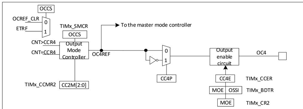
图 18-30 捕获/比较通道的输出部分(通道 4)
