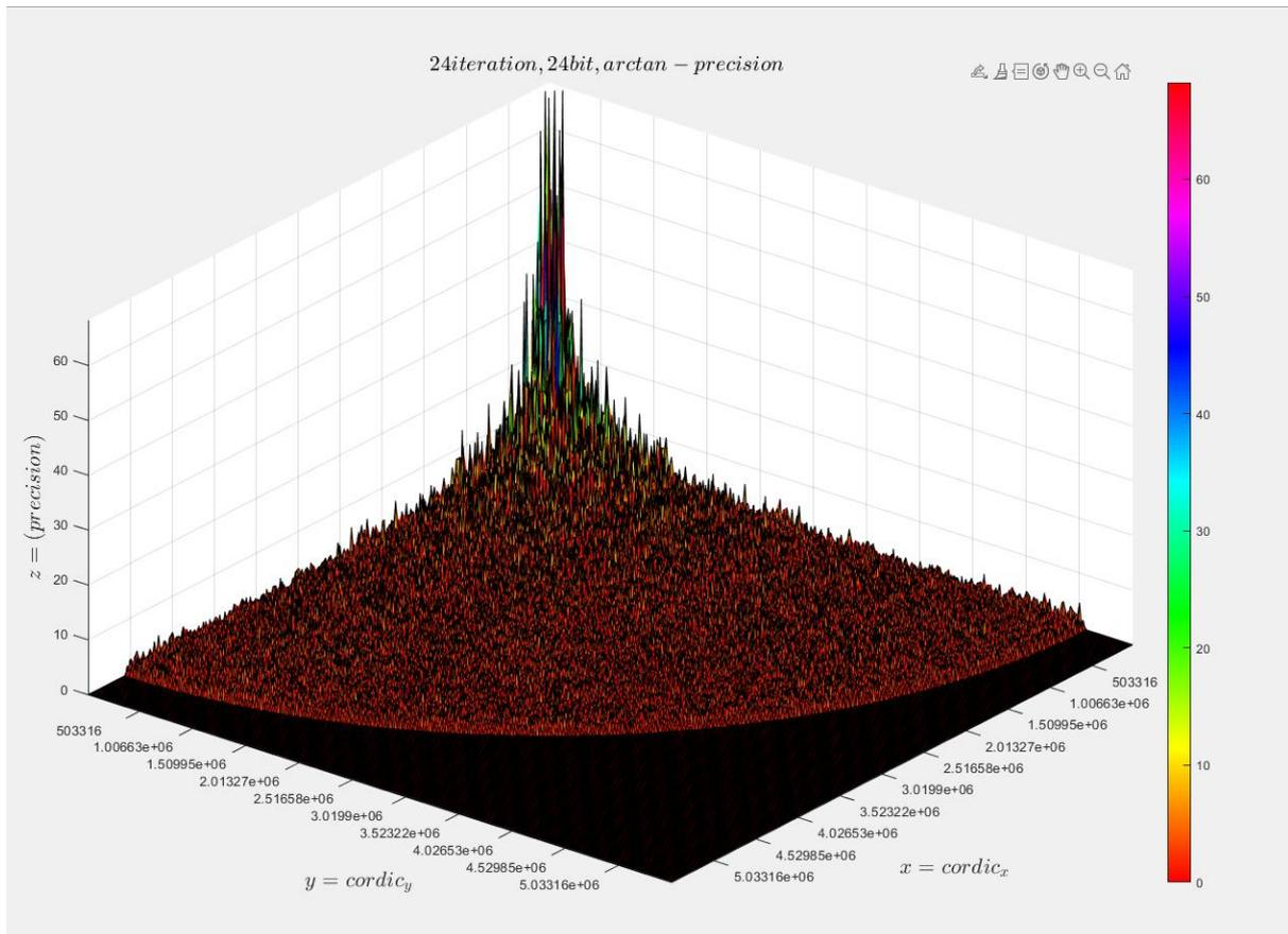
从图上可得，当圆周系统的半径靠近圆心时，误差最大。半径大于某个值后，发生溢出(电路做处理，溢出后 arctan 结果为 0)。
