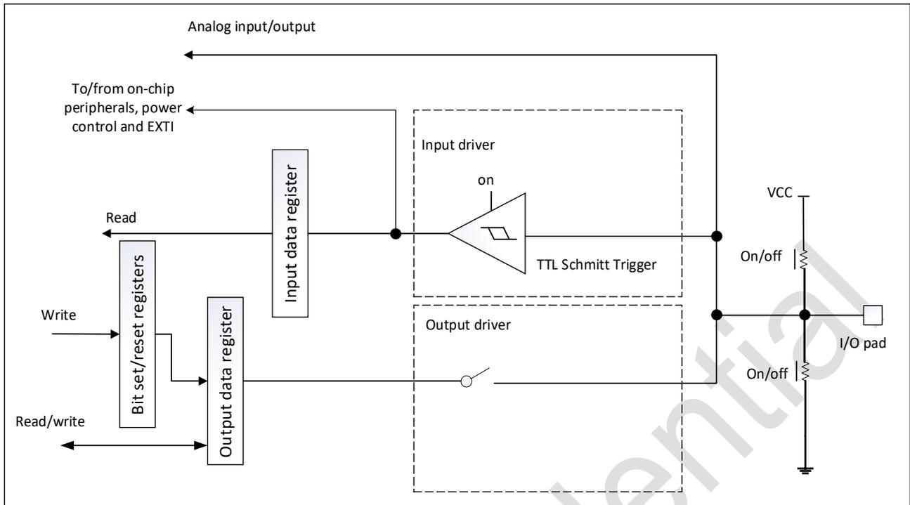
图 9-2 输入浮空/上拉/下拉配置
