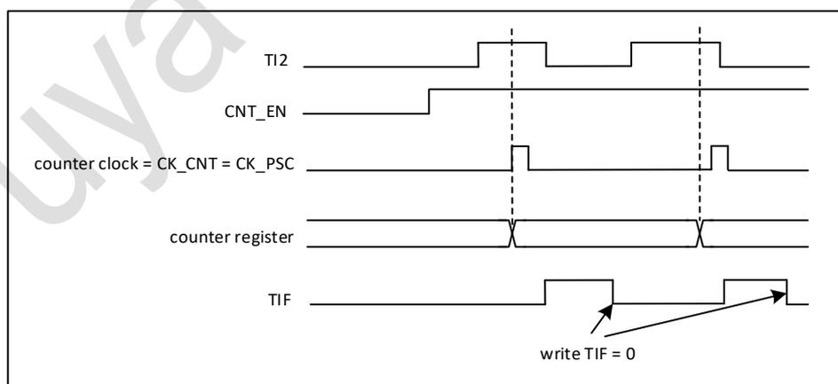
图 19-23 外部时钟模式 1 下的控制电路
