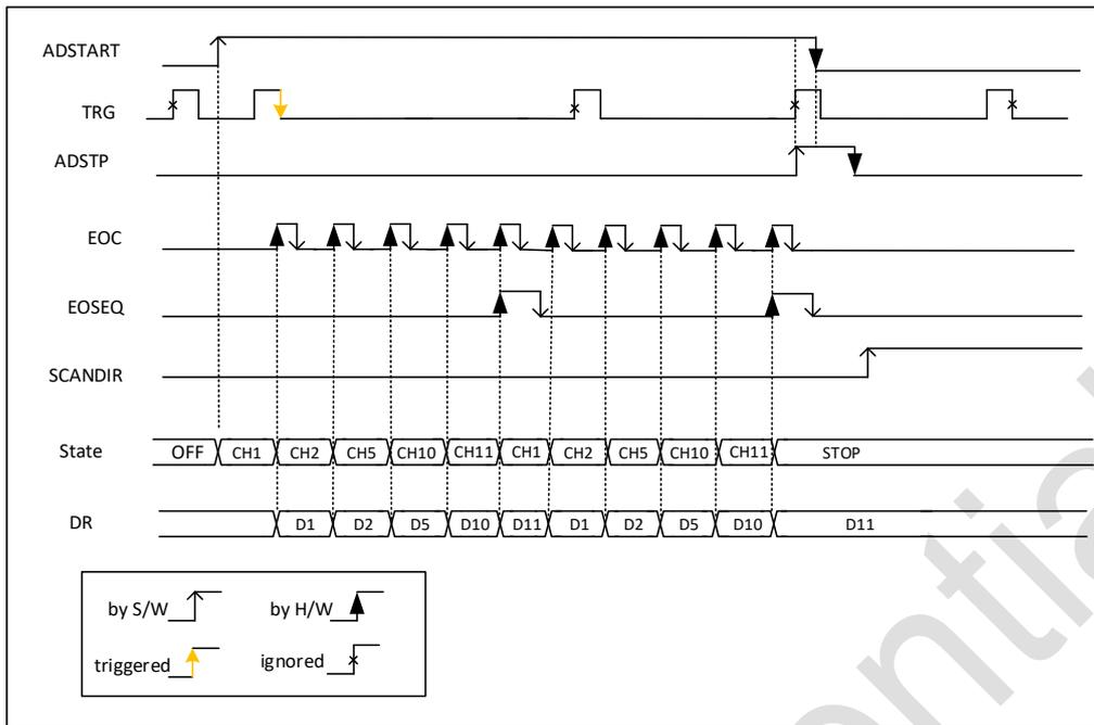
图 14-10 序列的连续转换，硬件触发
