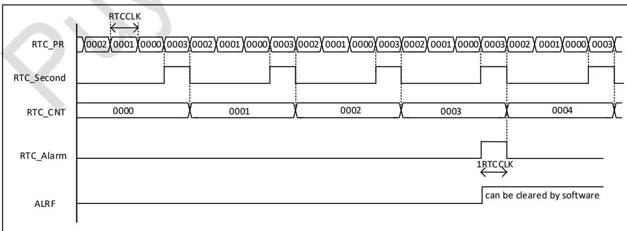
图 26-2 RTC 秒和闹钟波形图示例，PR=0003，ALARM=00004
