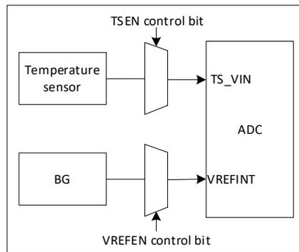
图 14-14 温度传感器和参考电压通道
