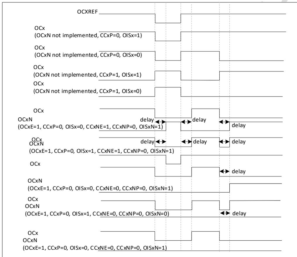
图 18-38 响应刹车的输出
