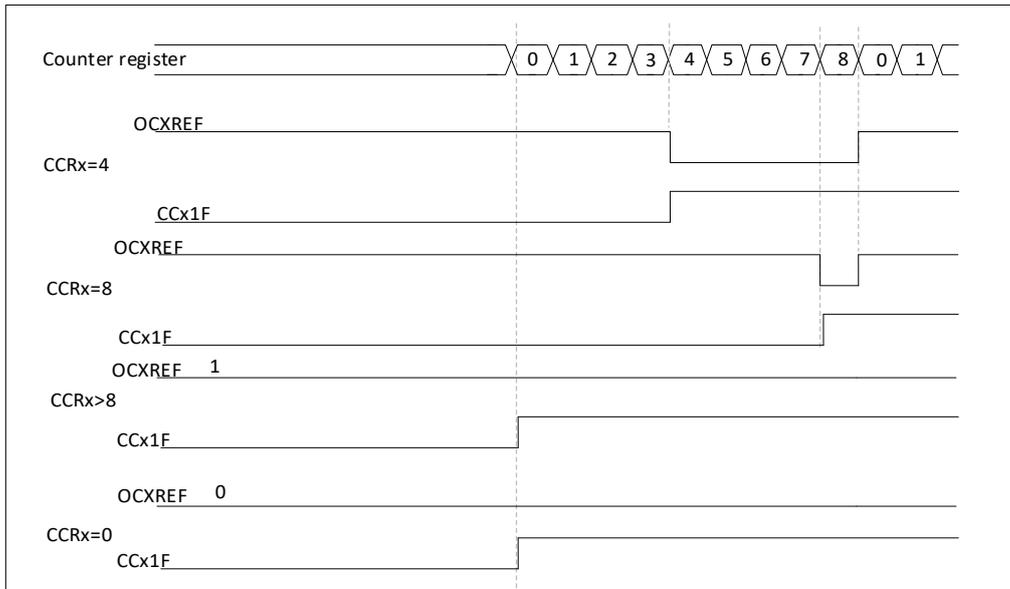
图 18-33 边沿对齐方式 PWM 输出，向上 (ARR=8)
