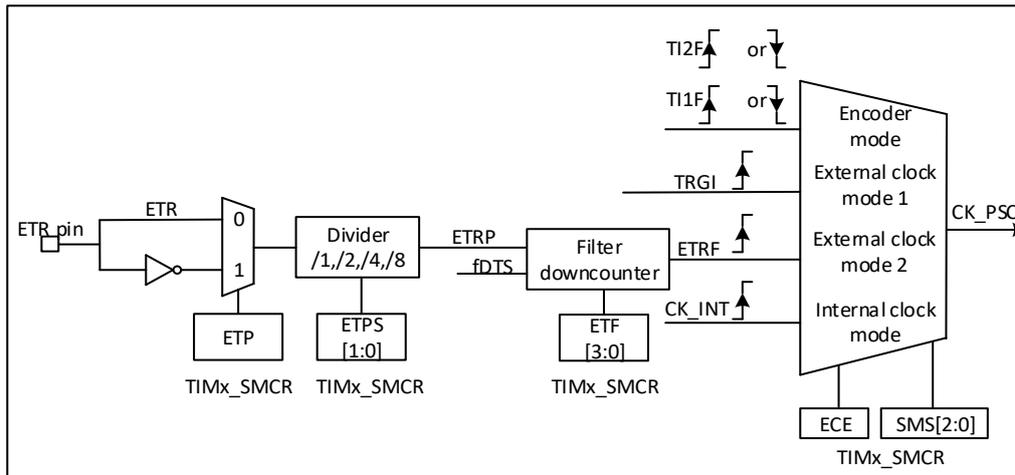
图 19-24 ETR 外部时钟连接示例
