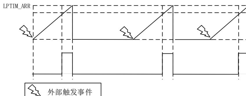
图 23-2 低功耗定时器输出波形，单计数模式
