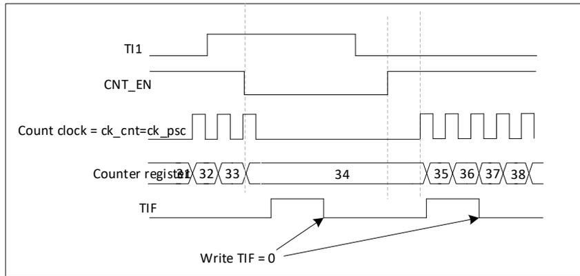
图 18-47 门控模式下的控制电路
