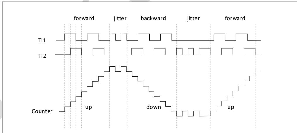
图 18-43 编码器模式下的计数器操作实例
