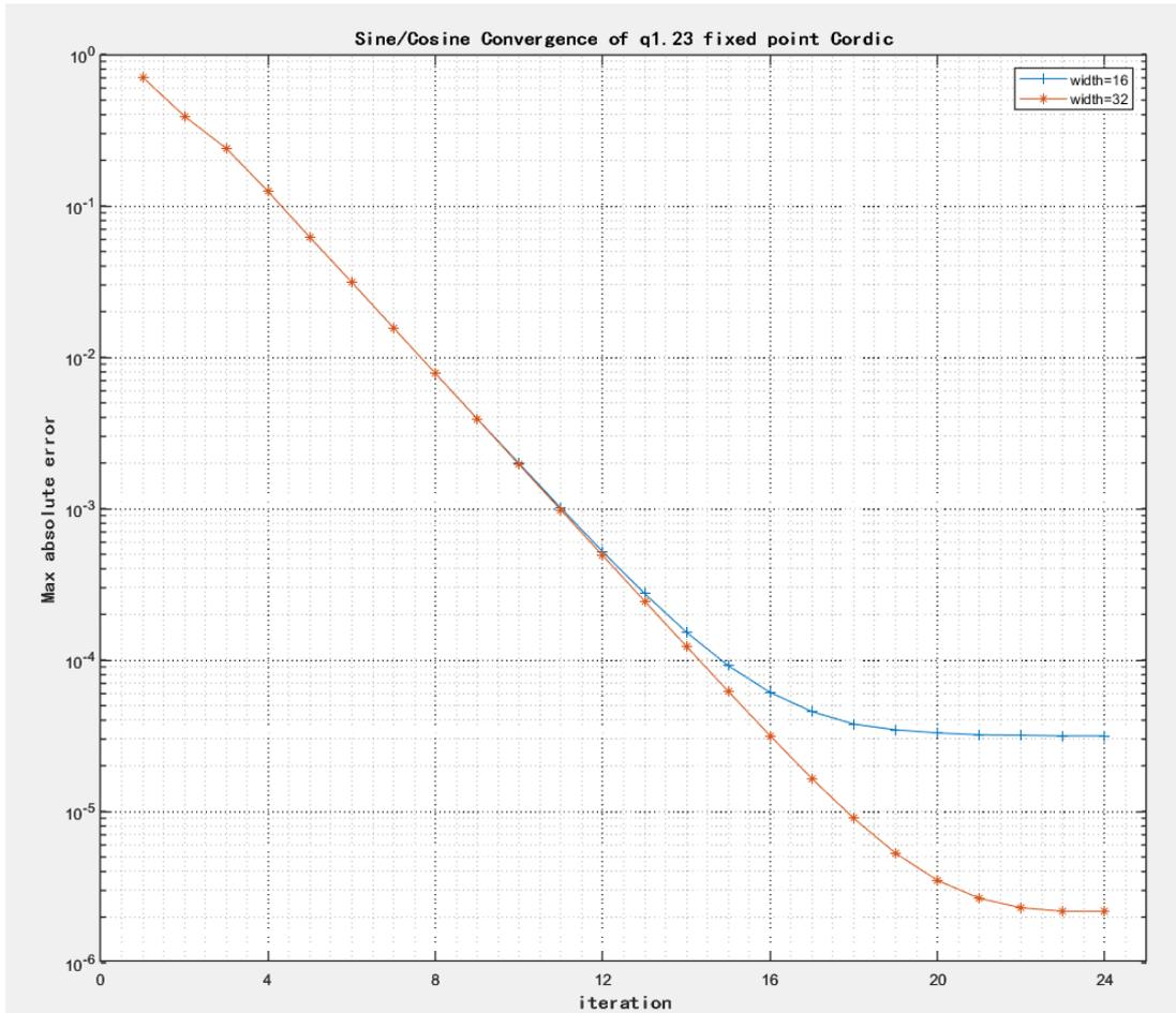
上图 X 轴为迭代次数，y 轴为最大误差，不同曲线为不同输入数据位宽，当迭代次数超过 16 次后，只有输入数据位宽为 32bit 的曲线精度还在增加，16bit 位宽的曲线精度增长已经触底。使用者可根据上图选择合适的迭代次数与输入数据位宽。
