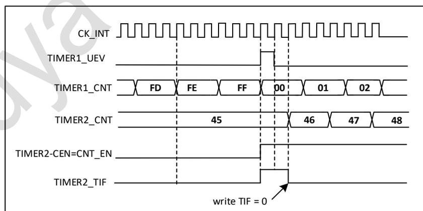
图 19-43 使用定时器 1 的更新触发定时器 2
