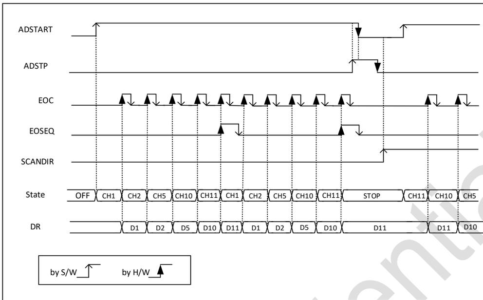
图 14-8 序列的连续转换, 软件触发
