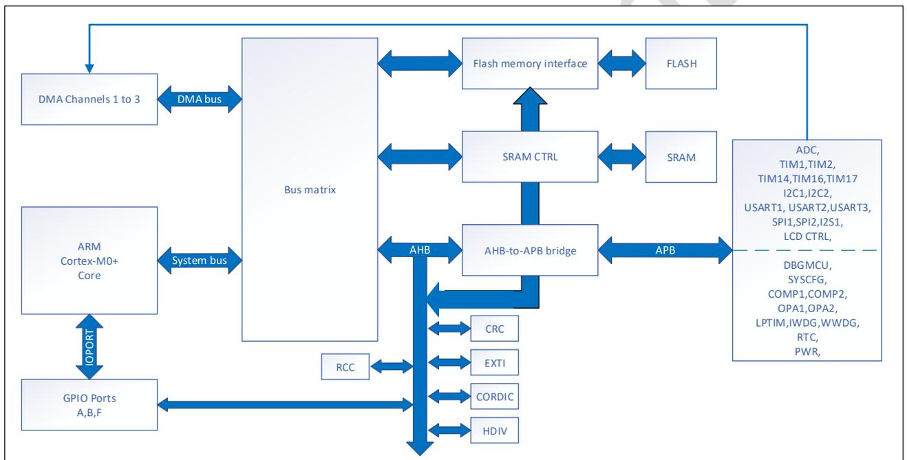
图 3-1 系统架构
