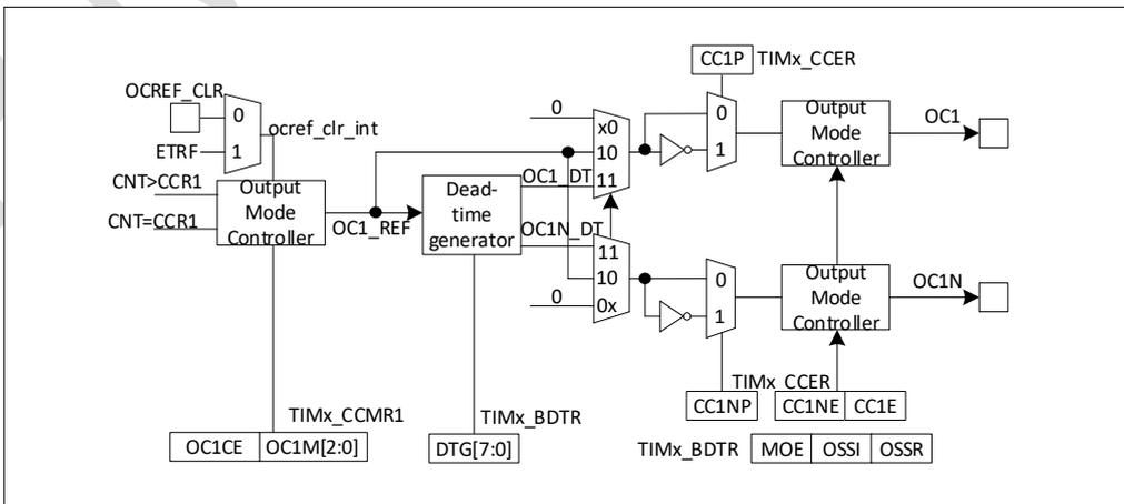
图 18-29 捕获/比较通道的输出部分(通道 1 至 3)
