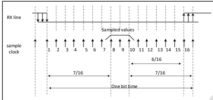
图 28-6 检测噪声的数据采样
