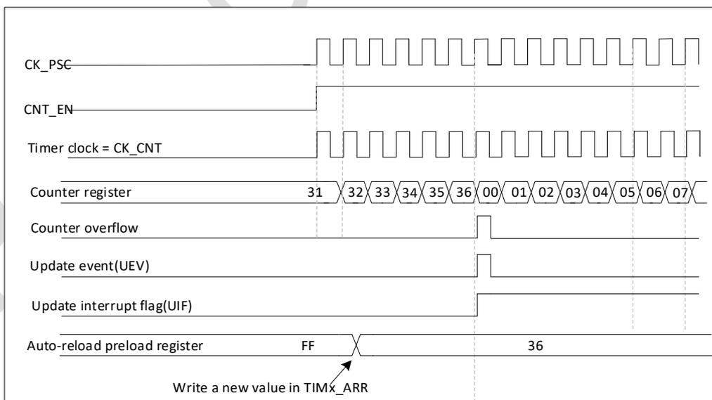
图 21-8 计数器时序图，当 ARPE=0 时的更新事件(TIMx\_ARR 没有预装入)
