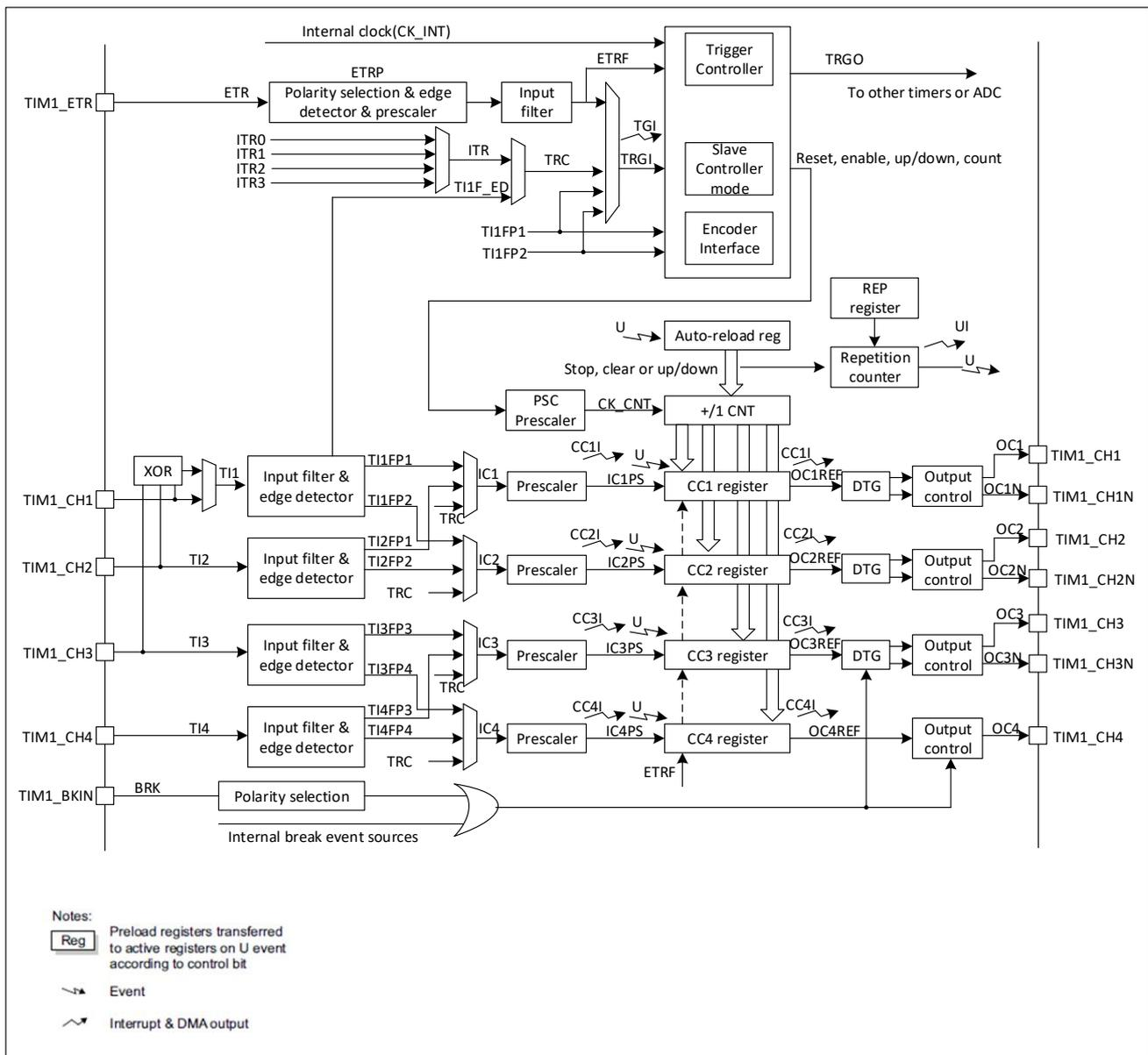
图 18-1 高级控制定时器架构框图
