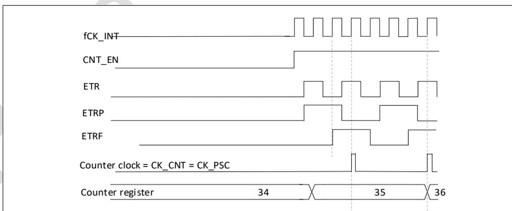
图 18-26 外部时钟模式 2 下的控制电路
