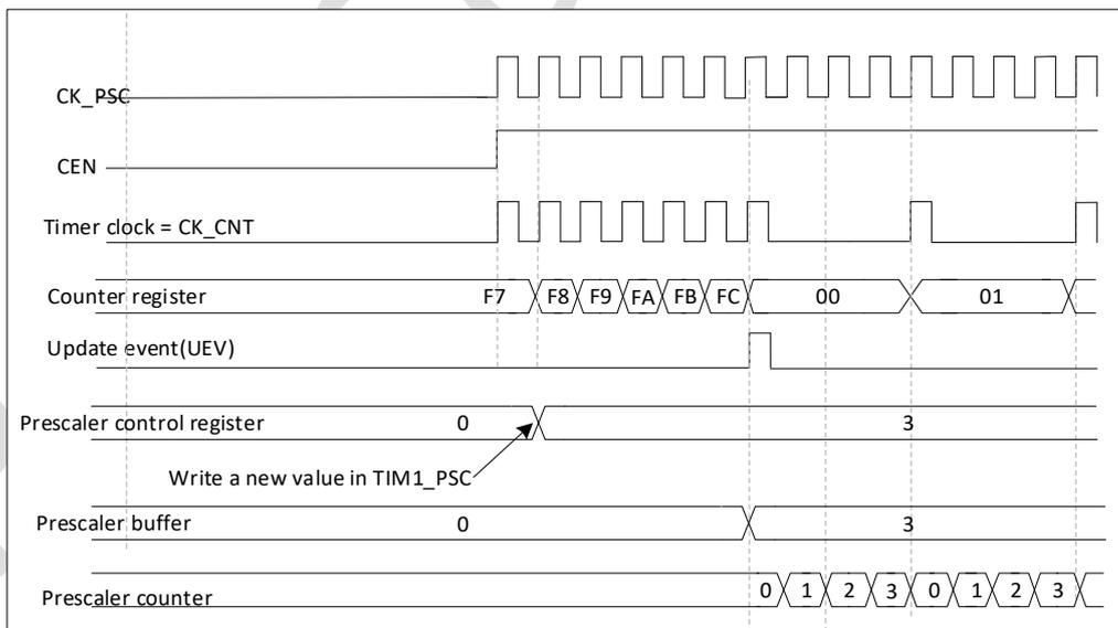
图 21-3 当预分频器的参数从 1 变到 4 时，计数器的时序图
