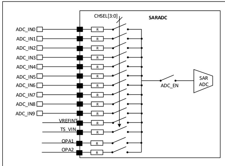
图 14-2 带模拟开关的 ADC 通道
