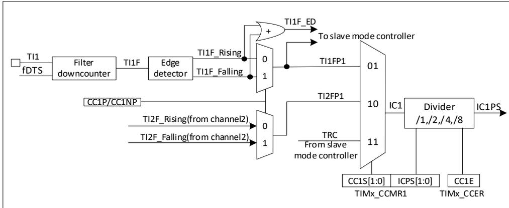
图 21-12 捕获/比较通道(如：通道 1 输入部分)
