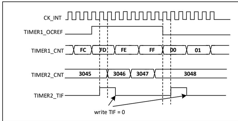
图 19-41 定时器 1 的 OC1REF 控制定时器 2
