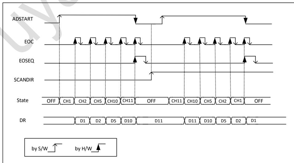
图 14-7 序列的单个转换, 软件触发
