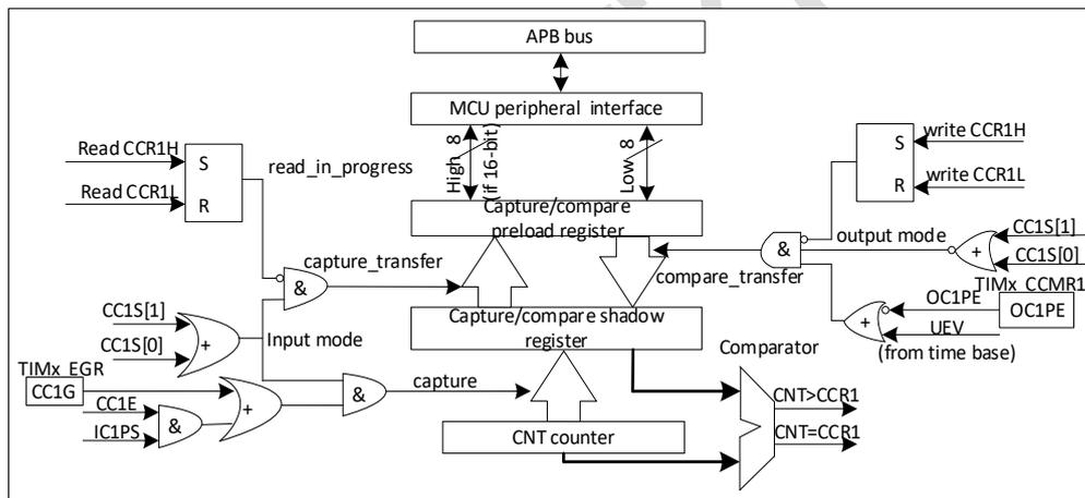
图 21-13 捕获/比较通道 1 的主电路
