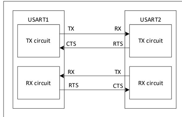
图 28-14 两个 USART 间的硬件流控制
