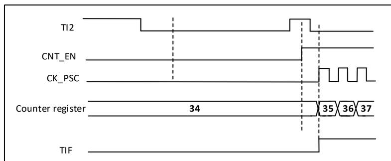
图 19-38 触发器模式下的控制电路
