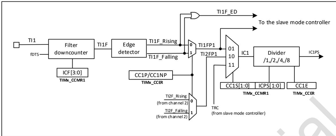
图 19-26 捕获/比较通道(如：通道 1 输入部分)
