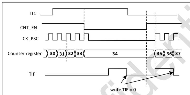
图 19-37 门控模式下的控制电路
