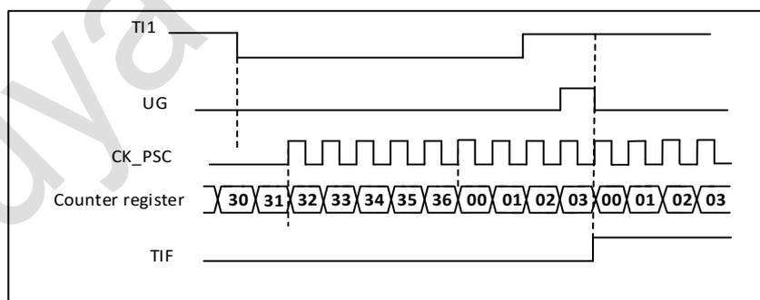
图 19-36 复位模式下的控制电路
