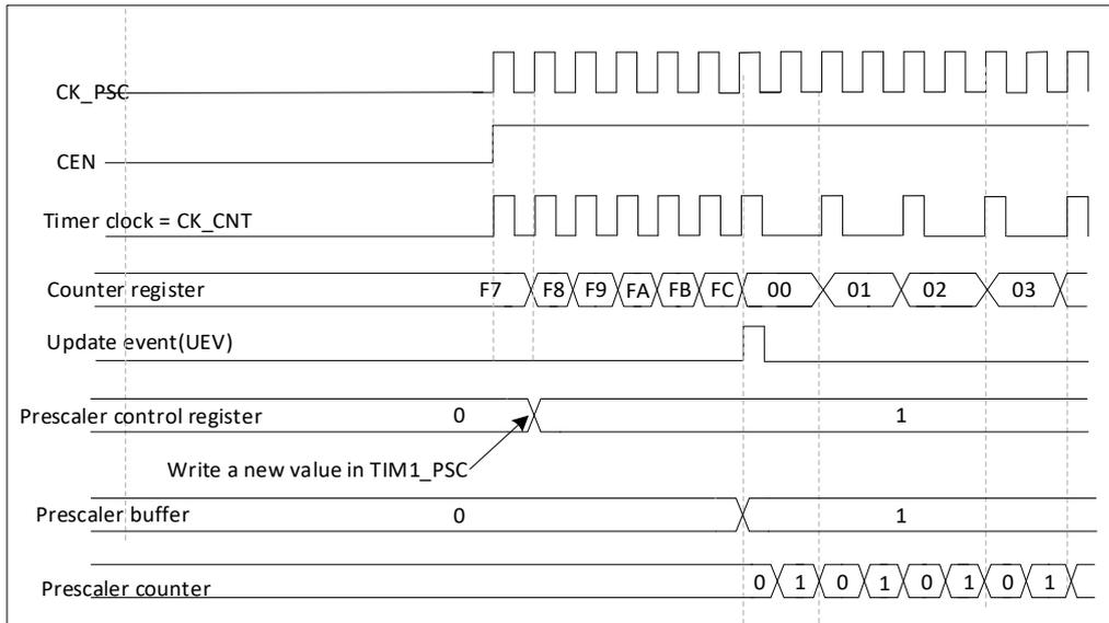
图 21-2 当预分频器的参数从 1 变到 2 时，计数器的时序图
