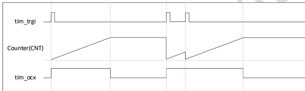
图 18-42 可重新触发单脉冲模式的示例
