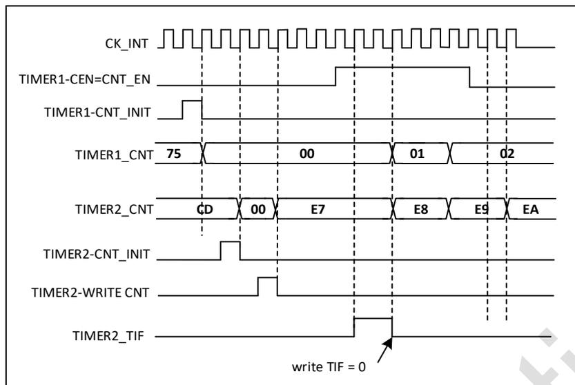
图 19-44 利用定时器 1 的使能触发定时器 2
