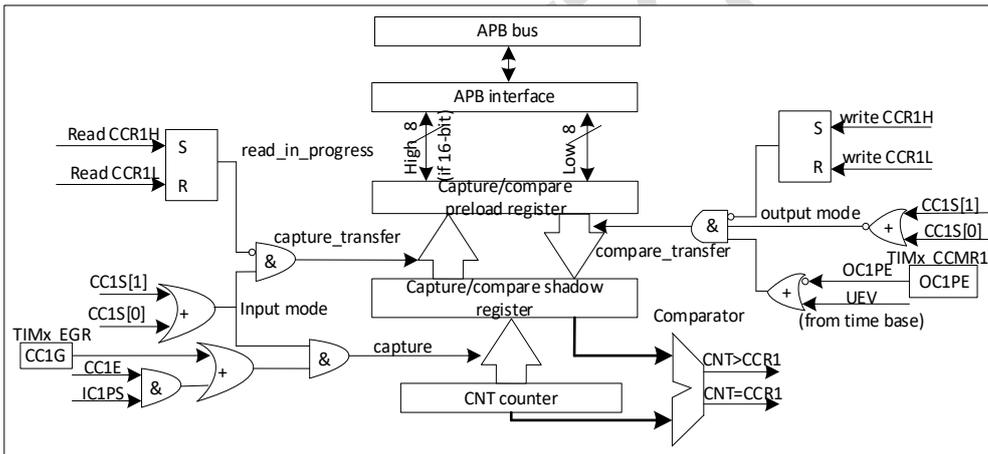
图 18-28 捕获/比较通道 1 的主电路
