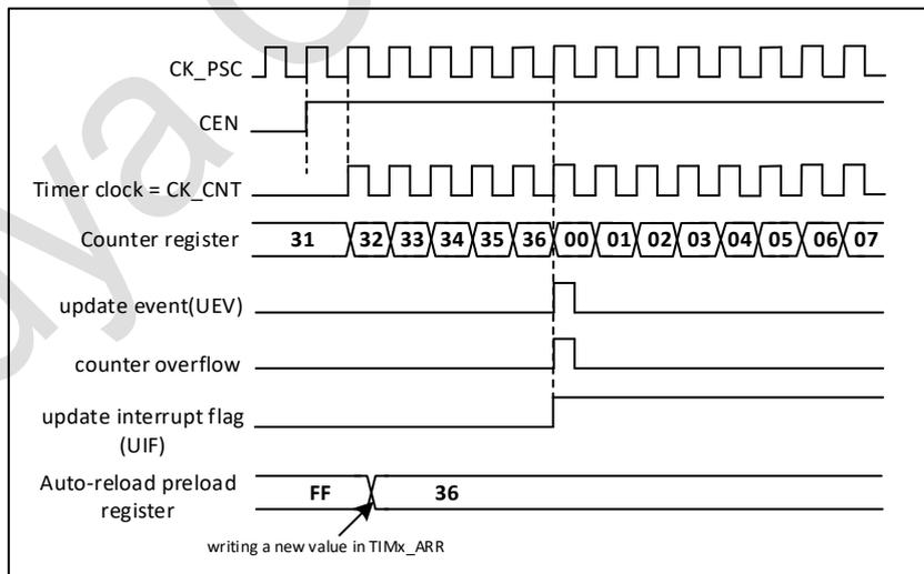
图 19-8 计数器时序图，当 ARPE=0 时的更新事件(TIMx\_ARR 没有预装入)
