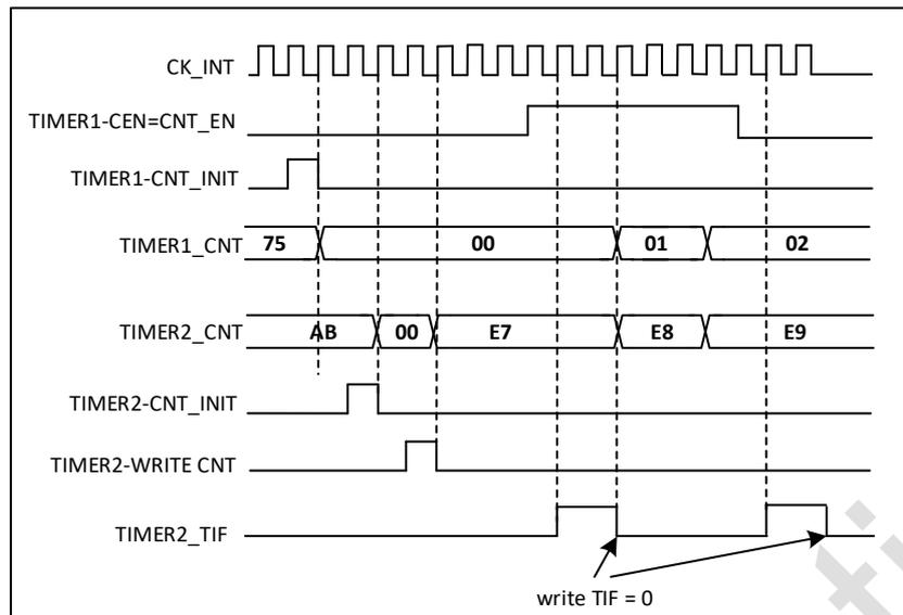
图 19-42 通过使能定时器 1 可以控制定时器 2
