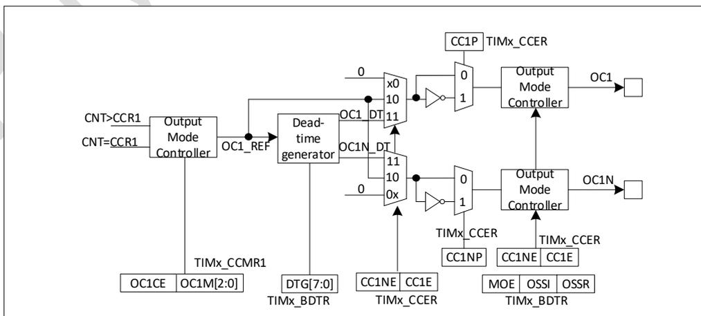
图 21-14 捕获/比较通道 1 的输出级
