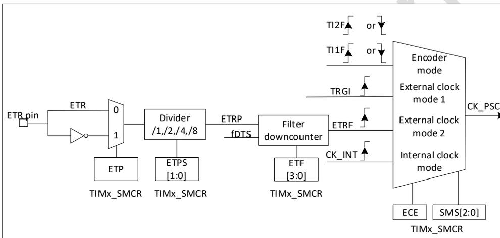
图 18-25 TI2 外部触发输入框图
