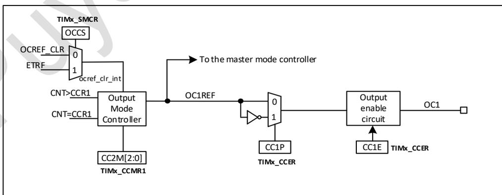
图 19-28 捕获/比较通道的输出部分(通道 1)
