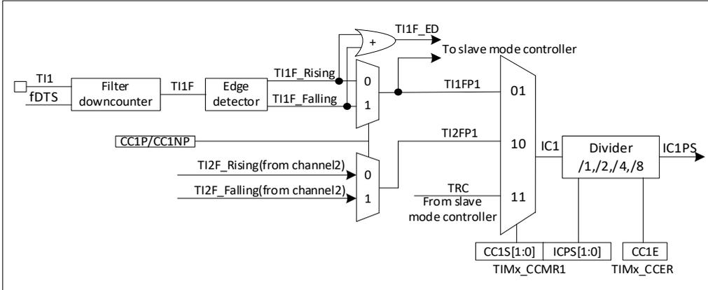
图 18-27 捕获/比较通道(如：通道 1 输入部分)
